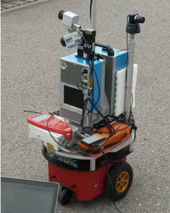
Abb. 3: Mobiler Roboter mit integriertem Sensorsystem für Forschung und Lehre
