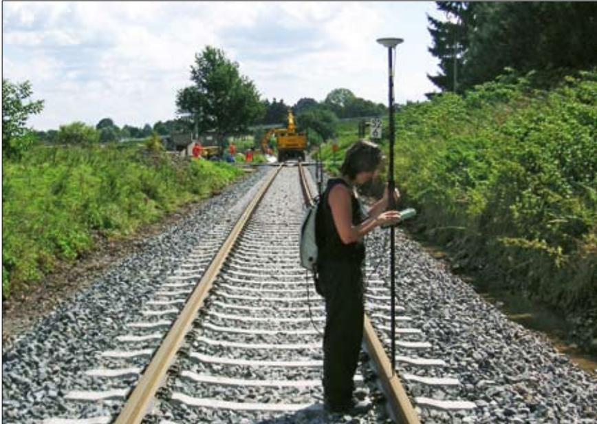
*Bild 1: Vermessungstechnikerin bei GPS-Aufnahme*
