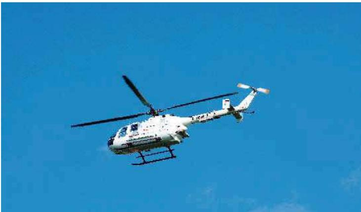
Bild 1: Helikopter als Versuchsträger für die Pipelineüberwachung mittels LIDAR. Später werden autonom fliegende Helikopter diese Aufgabe übernehmen.
