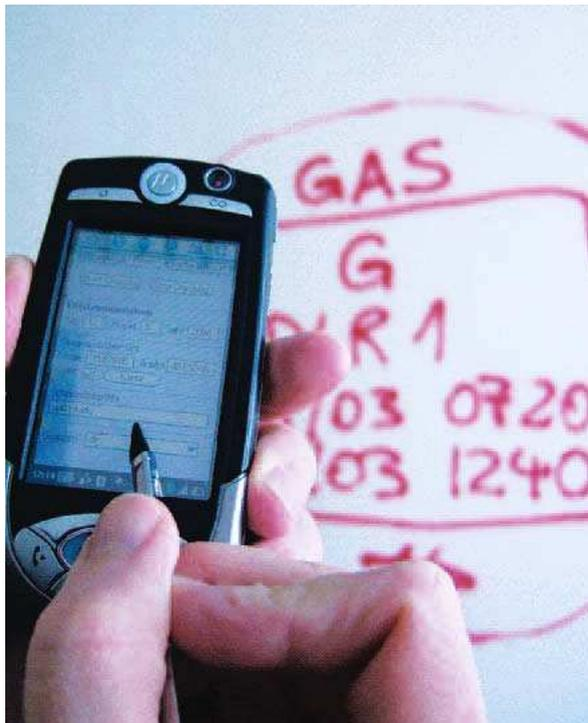
*Bild 3:* Im Hintergrund: Konventionelle Sprühmarkierung eines Gebäudes nach INSARAG (International Search and Rescue Advisory Group). Durch die georeferenzierte Übertragung in den »Information Space« (im Vordergrund) steht diese Information allen Hilfskräften elektronisch zur Verfügung und kann zur Optimierung der Einsatzlogik verwendet werden.
