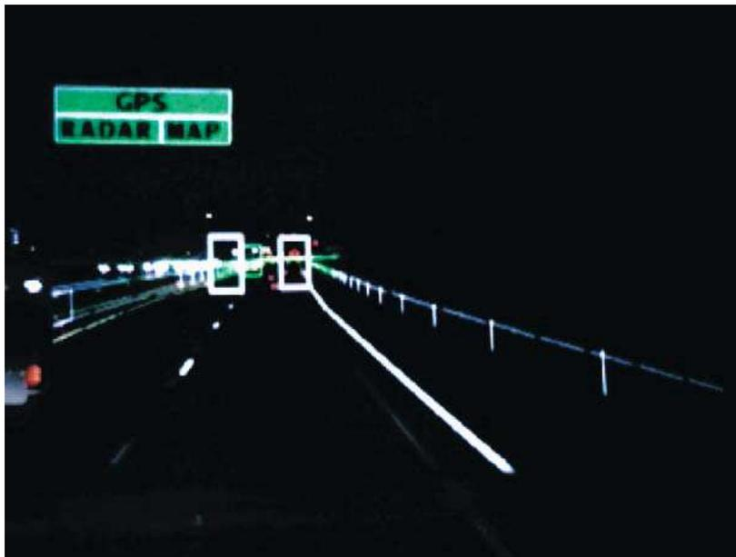
*Bild 2:* Blick durch den halbdurchlässigen Bildschirm eines Schneepfluges auf die Straße. Die eingeblendeten Fahrbahntrenn- und Begrenzungslinien ermöglichen die Orientierung bei Schnee oder sonst behinderter Sicht. Die Rechtecke beschreiben vom Radar erfasste Hindernisse. Bisher wurden 8 Schneepflüge in Minnesota und Alaska ausgerüstet
