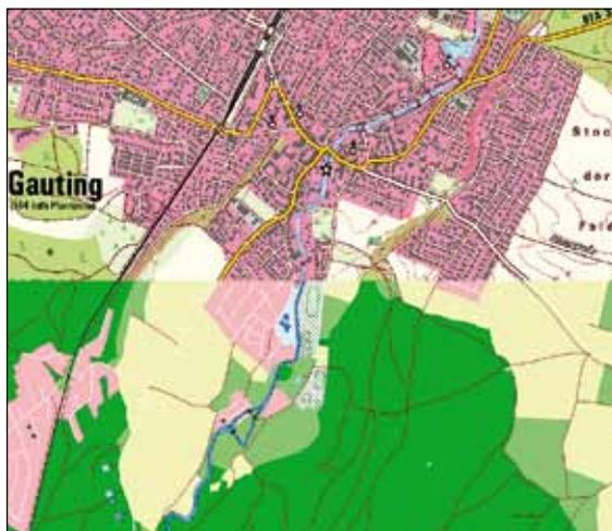
*Bild 1: ATKIS (untere Hälfte) als Ausgangsdaten für die DTK25 (obere Hälfte)*
