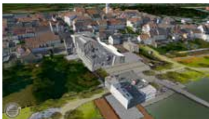
Bild 6: Automatisiert texturiertes LoD2-Modell mit Bildern aus einer Schrägluftbildbefliegung und einem integrierten Gestaltungsplan der Landesgartenschau; per Mausclick zu entfernen- des fehlerhaft texturiertes Gebäude (links), Präsentation eines Gebäudeneubaus (rechts)
