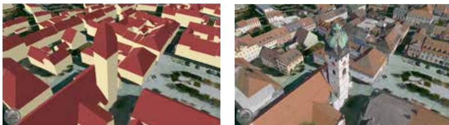
Bild 8: Standardisierte Kirchturmspitze eines Zwiebelturms im LoD2 als Turmdach (links) und den zerfallenen Texturen (rechts)
