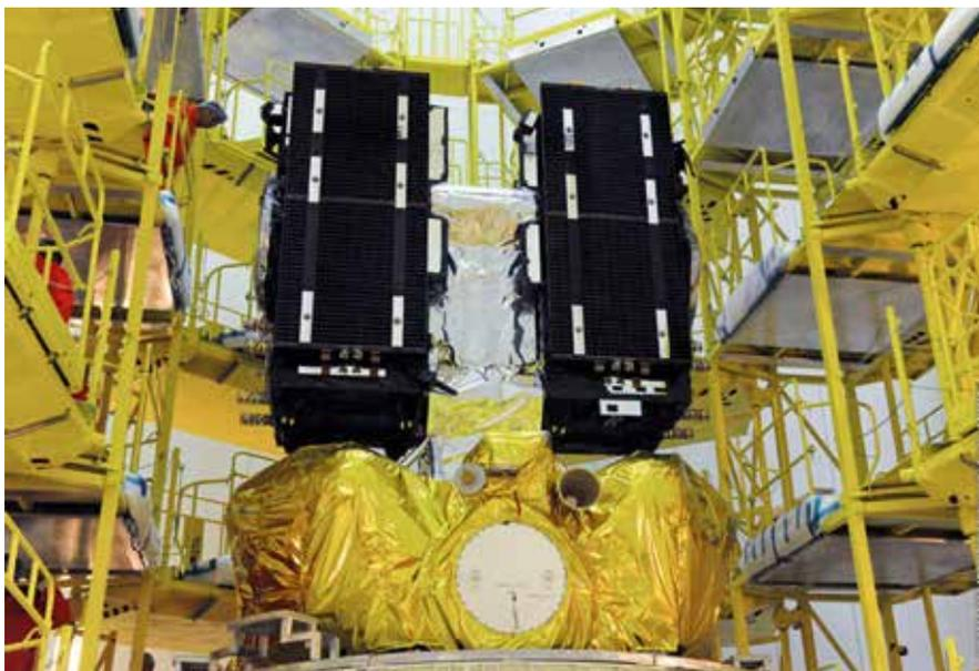
*Bild 11: Die Galileo Satelliten auf der Haltevorrichtung der Oberstufe Fregat*
