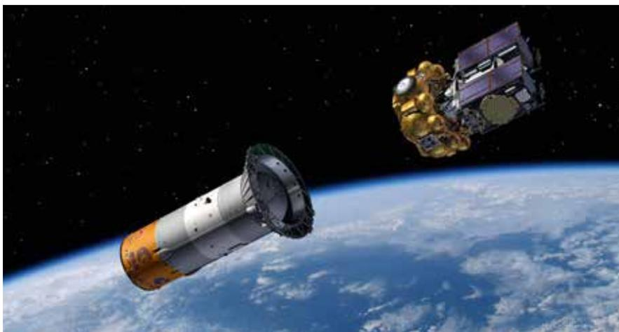
*Bild 12: Abtrennung der Oberstufe Fregat von Haltevorrichtung mit den befestigten Galileo Satelliten*
