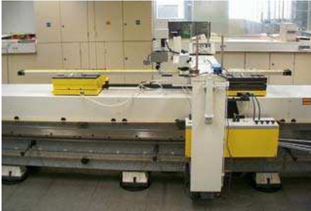
Bild 4: Horizontalkomparator der Universität der Bundeswehr München (Quelle: Institut für Geodäsie der Universität der Bundeswehr München)
