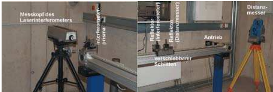
Bild 1: Messbahn zur Kalibrierung von Distanzmessern
