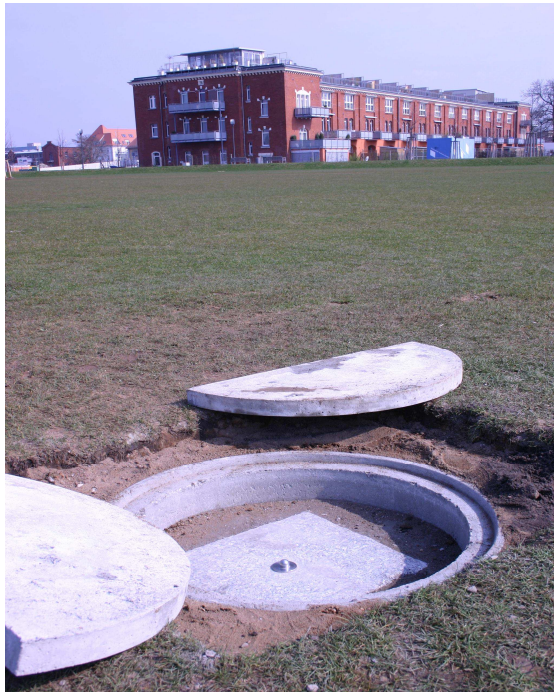
Bild 15: Der 1997 geschaffene Absolutschweresfestpunkt in Fürth, Südstadtpark
