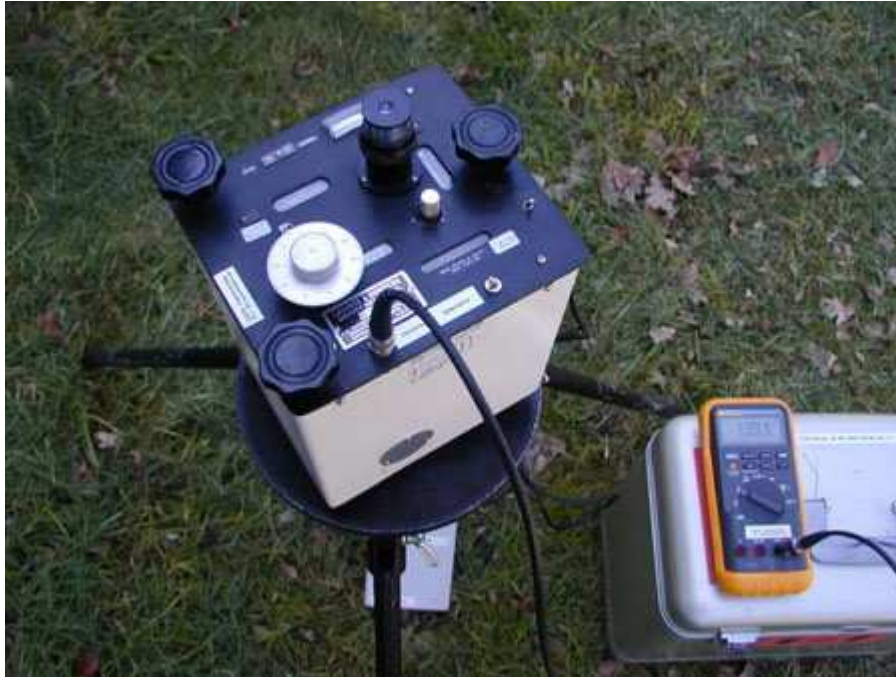
Bild 10: Ein LaCoste & Romberg-Gravimeter mit herkömmlichen Blasenlibellen und externer Ablesemöglichkeit über Voltmeter
