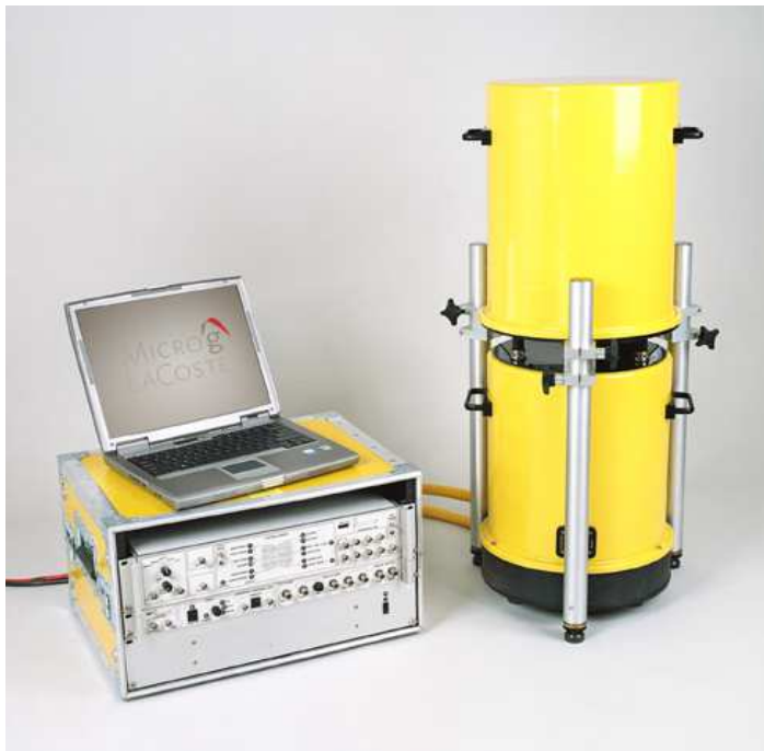
Bild 7: Das A-10 - Absolutgravimeter des Bundesamt für Kartographie und Geodäsie
