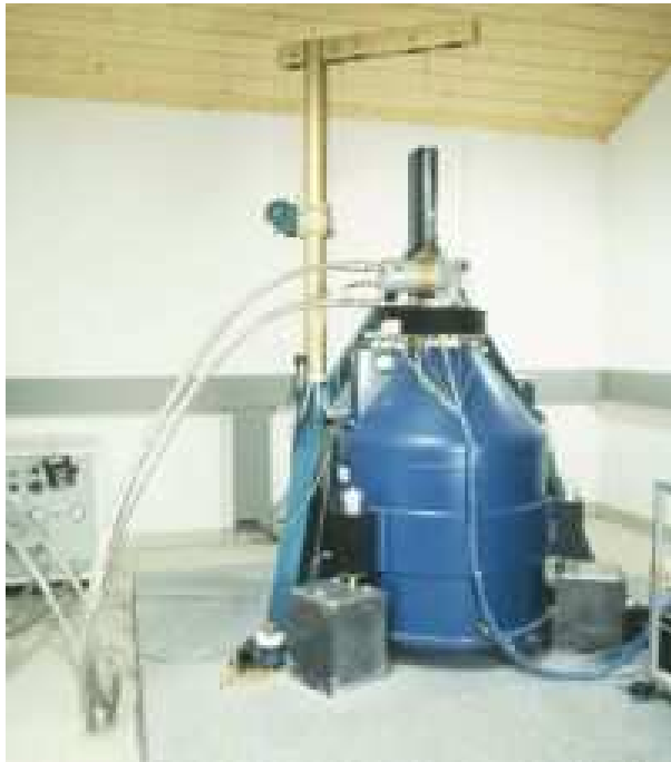
Bild 8: Supraleitendes Gravimeter CD 029 in Wettzell
