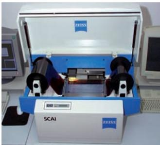
*Bild 3: Photogrammetrischer Präzisionsscanner SCAI der Fa. ZEISS*
