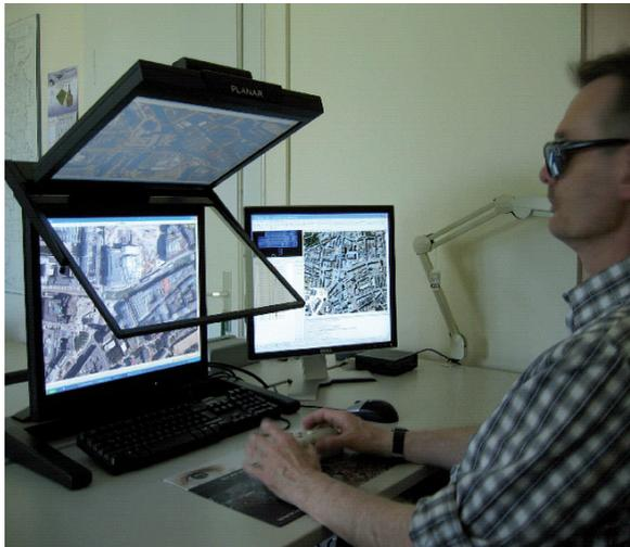
*Bild 18:* Stereoskopische Auswertung an einem modernen Planarsystem
