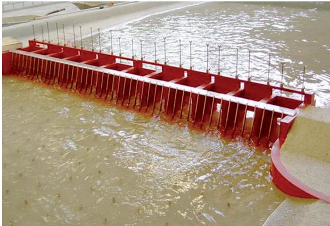
*Bild 6:* Modellversuch Einlaufbauwerk des geplanten Flutpolders Feldolling (aus Hartlieb 2007)
