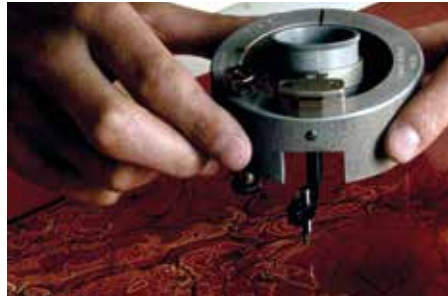
Schichtgravur auf Glas mit Gravurring und eingespanntem Gravurstichel
